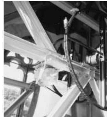
Ein Läutantrieb besteht aus Antriebsmotor, der Läutmaschine bzw. dem Steuerschalter und dem Antriebsrad mit Kette.
